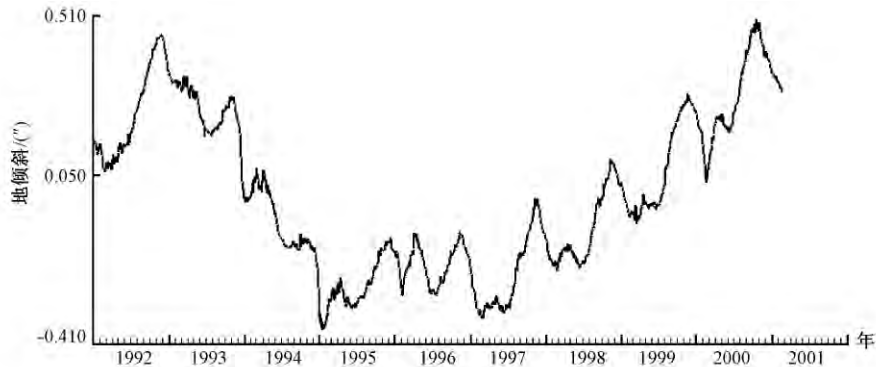
图 5 精河台水平摆 NS 向第 1 时段与直线 y = 80.82467 - 0.00169x 拟合之差
