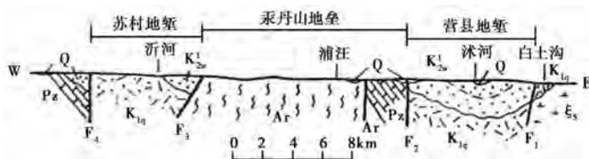
图 1 沂沭断裂带横剖面结构(据国家地震局地震研究所(1987))
