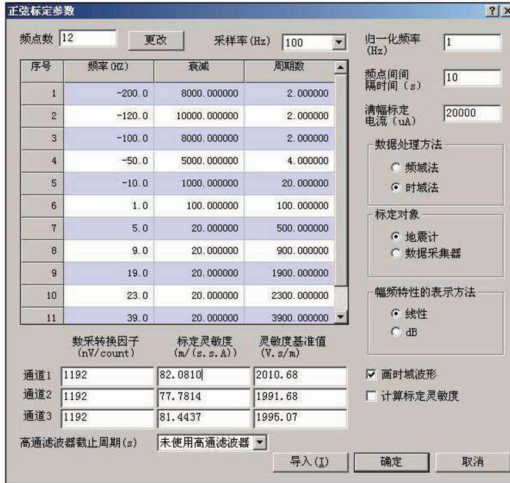
图 4 Edsp-icheck 软件正弦标定参数设置界面
